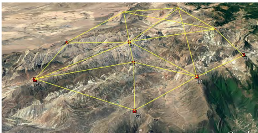
نمونه‌ای از شبکه‌ی نقاط اصلی نقشه برداری که روی مناطق مرتفع ایجاد شده است. خطوط زرد رنگ نشان‌دهنده‌ی قرائت‌های همزمان گیرنده‌های جی‌پی‌اس هستند
