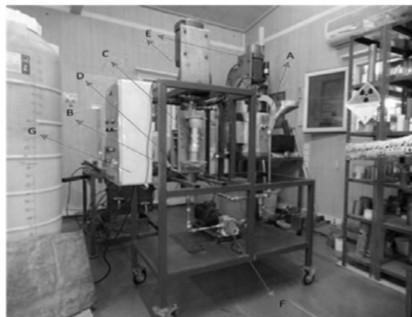
۲ | نماهایی از لوپ (A) مخزن آماده‌سازی سوسپانسیون/امولسیون، (B) مخزن همگن‌سازی، (C) آشکارساز سوسوزن، (D) حفاظ سربی چشمه‌ی رادیواکتیو گاما، (E) الکتروموتورها، (F) بورد الکترونیکی کنترل دستگاه. با تضمین حضور یک مخلوط دوفازی همگن امکان اندازه‌گیری کسر حجمی فازها با استفاده از روش گامای عبوری فراهم می‌شود.
